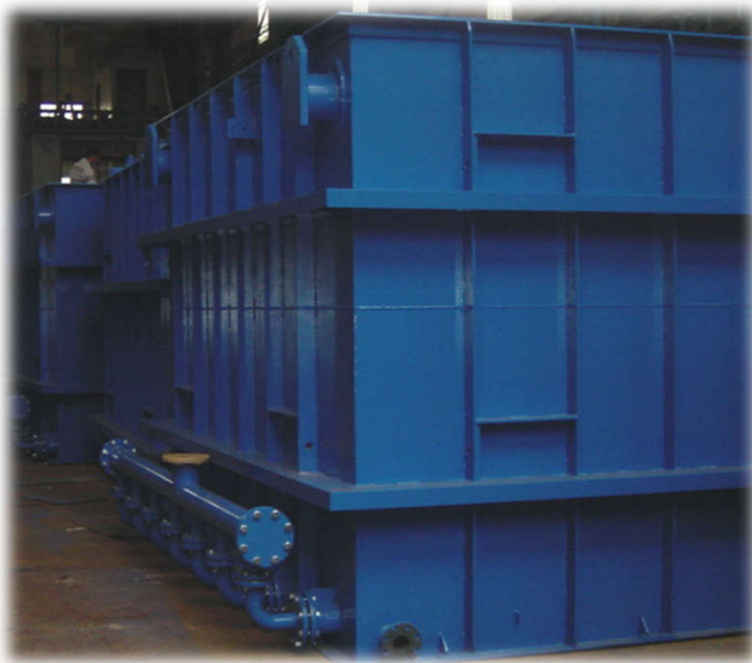
廢水處理儲槽
